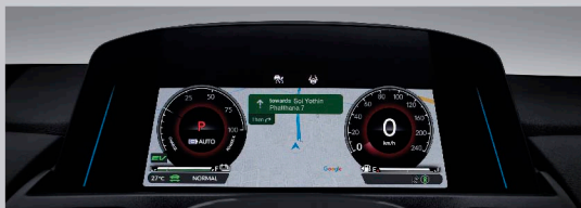
10.2" TFT Multi-information Display มาตรวัด พร้อมหน้าจอแสดงข้อมูลการขับขี่แบบ TFT ขนาด 10.2 นิ้ว
