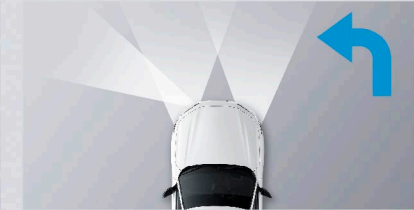
Active Cornering Lights (ACL) ไฟส่องสว่างด้านข้างอัตโนมัติขณะเลี้ยว
