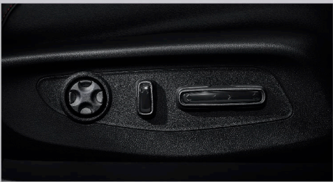
8 Way Power Passenger Seat เบาะนั่งผู้โดยสารด้านหน้าปรับไฟฟ้า 8 ทิศทาง
